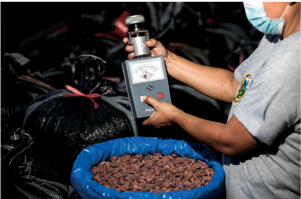
Fotografía 28: Medición de la humedad de grano de lote de cacao.
